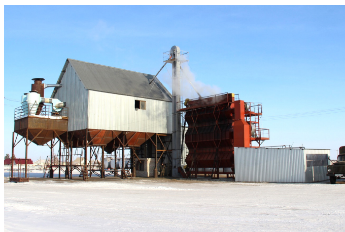
Сушка подсолнечника в ООО "Степное" (Алтайский край), сушилка зерна СЗ-16, 3 декабря 2014 г., t = -12°C
